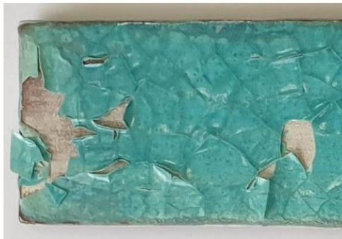
Resim 21. Tek renk sırlı çini karo (Işıl Konak üretimi), sırda kavlama.
