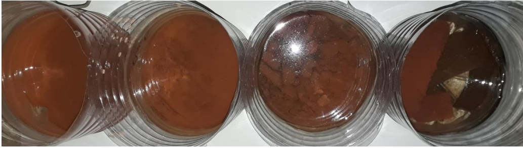
Görsel 10. Soldan sağa, 423, 473, 523, 573°C derecelerde pişen çamur plakaların el ile ezildikten sonraki durumları. (14. 11. 2019)
