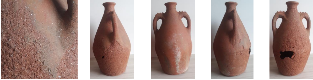
Görsel 1. Düşük pişirim (pekişmeden pişirimin sonlanması) nedeni ile bozulma örneği. Formun bozulan yüzeyini gösteren detay ve dört yönüne ait fotoğraflar. (26. 11. 2019)
