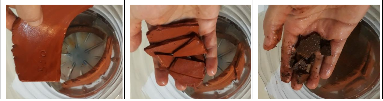
Görsel 9. 573°C derecelerde pişen çamur plakaların 28 gün suda bekledikten sonrası ve avuç içinde ezilmesi. (14. 11. 2019)
